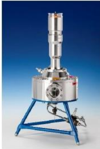
Abb. 2: Gerät zur Bestimmung der Normspaltweite nach ISO/IEC 80079-20-1
